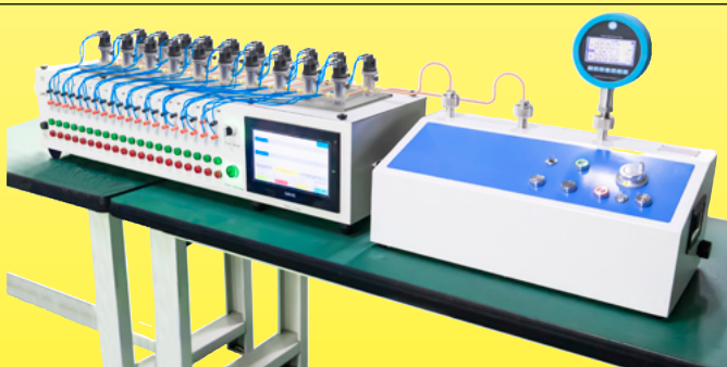
Verificación de la calibración de los presostatos
